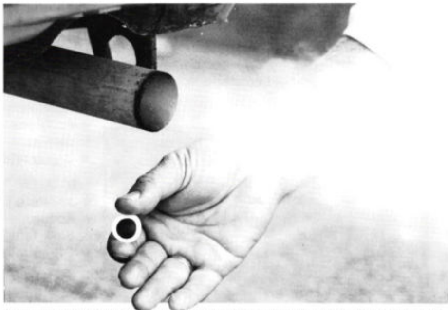
Deze meetelektrode is het hart van het door AEG-Telefunken ontwikkelde elektrochemische instrument voor de emissiemeting van stikstofoxyde. Met dit instrument kunnen onder meer in auto's gemonteerde katalysatoren op de goede werking worden gecontroleerd, door meting van het uitlaatgas.
