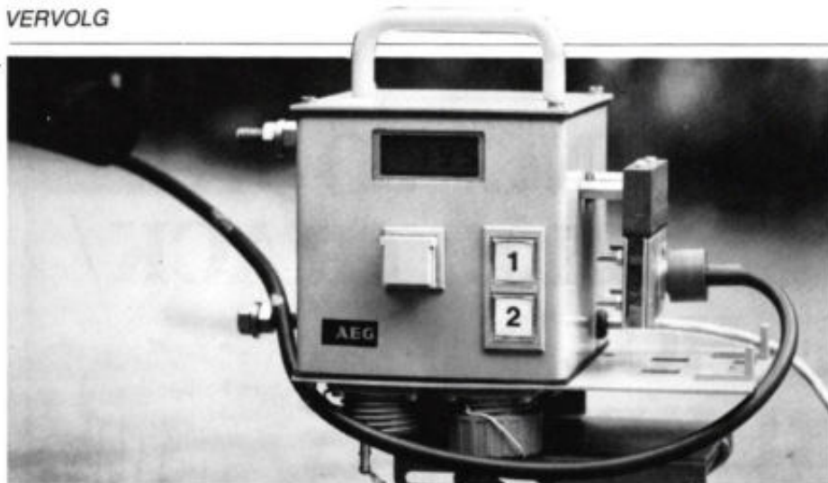
Afb. 7. Laboratorium-model van het door AEG-Telefunken ontwikkelde elektrochemische meetinstrument voor bepaling van stikstofoxyde in gassen. In de rechts bevestigde meetcel vindt een elektrochemische reactie plaats waaruit door stroommeting de stikstofconcentratie volgt.
